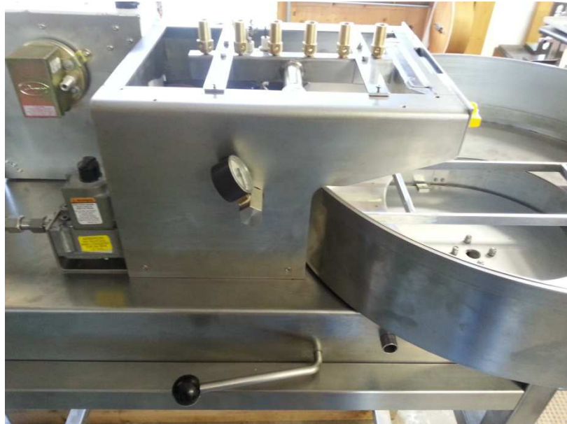
Abbildung 15: Seitenansicht links mit Gasventil, Sensor und Manometer
