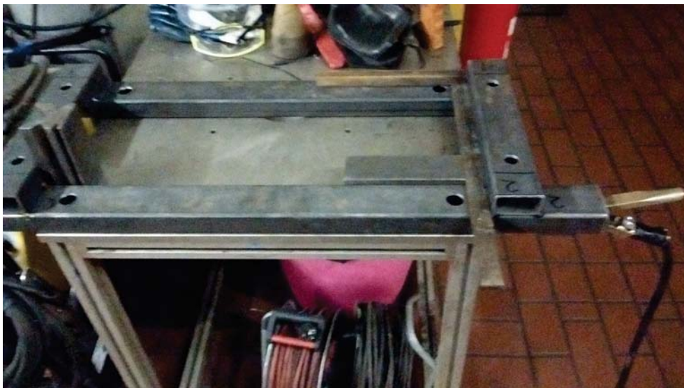
Abbildung 8: Fixieren der Rechteckrohre
